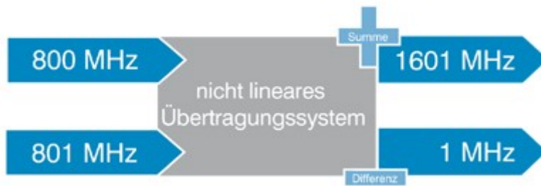
Abb. 9 – Intermodulationen 2. Ordnung Quelle: www.shure.de
